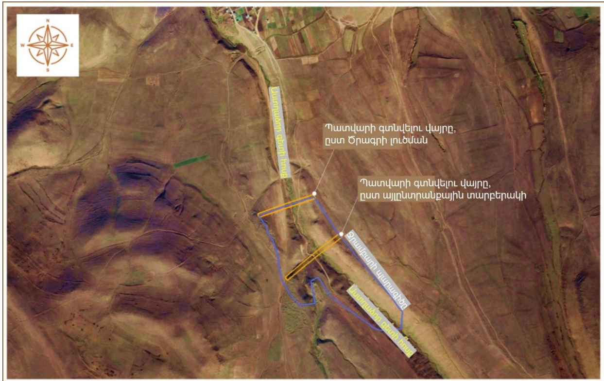
Նկար 3-4. Սողանքային գոտիների հիմնական և երկրորդային ճեղքվածքներ
